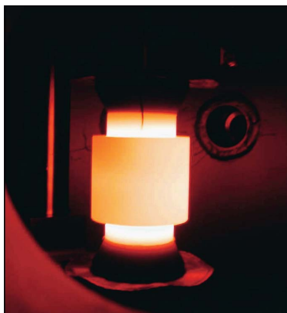
Рис. 2 • «Высокоскоростная» печь при рабочей температуре 1800 °С
