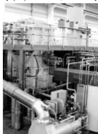
Рис.4 Индукционные печи для спекания в инертной атмосфере с полезным объемом 700 и 1000 л., с системами термического отжига и охлаждения путем циркуляции газа.
