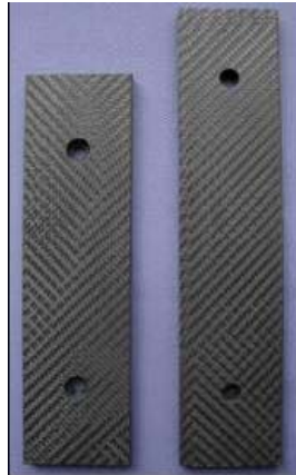
Рис.7 a,b: Элементы сцепления и тормозных колодок из C/C-SiC с высоким коэффициентом трения, не зависящим от уровня влажности.
