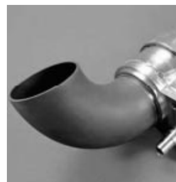
Рис.12 Аспирационный блок системы шлифования рельсов со склеенными SiC-элементами.
