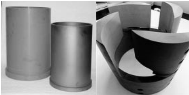
Рис.9 (слева): Футеровка мельниц из SiC: прессованная и обработанная в сыром виде, а также готовая – после спекания и чистовой обработки (D=400 мм) (справа): рабочий образец ротора мельницы с активаторными вставками (D=200 мм)
