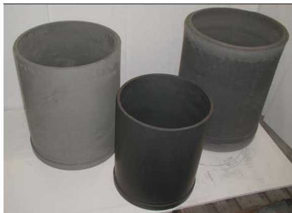
Рис.1 Брони мельницы из \text{SiC} : сырая заготовка, обработанная заготовка, спеченная заготовка
