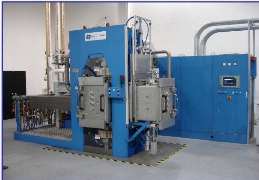
Abbildung 10: FAST (SPS)-Produktionsanlage: HP D 250/C, Semi-Kontinuierlicher Betrieb
