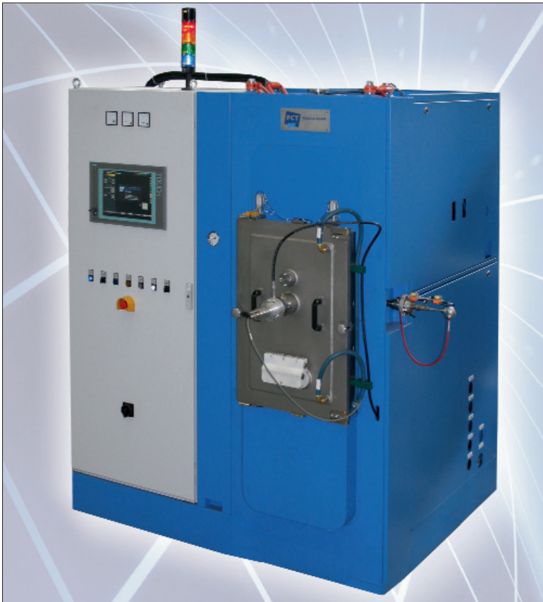
Bild 9 Neuentwickelte 250 kN FAST/SPS-Anlage
