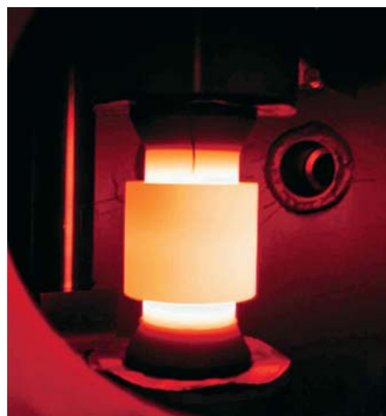
Bild 2 • „High Speed“-Ofeneinsatz bei 1800 °C Betriebstemperatur
